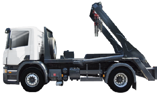
Εικόνα 2: Απορριματοφόρο τύπου Skip Lift μεταφοράς κοντέινερ
