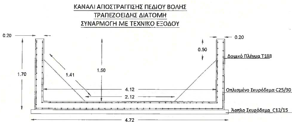
Εικόνα 2.5 Τυπική ορθογωνική διατομή για την συναρμογή της αποστραγγιστικής τάφρου με το υφιστάμενο τεχνικό εξόδο (άνευ κλίμακα).
