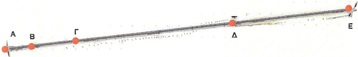
Εικόνα 2.2 Οριζοντιογραφία αποστραγγιστικής τάφρου (άνευ κλίμακα). Το Α είναι το πέρας της τάφρου, στο Β βρίσκονται δύο υφιστάμενοι κυκλικοί οχετοί, το Γ είναι αλλαγή κλίσης και διατομής της τάφρου, το Δ είναι το σημείο όπου κατασκευάζεται κιβωτοειδής οχετός 2,0 \times 1,5 \text{ m} και το Ε είναι το σημείο αρχής της αποστραγγιστικής τάφρου.
