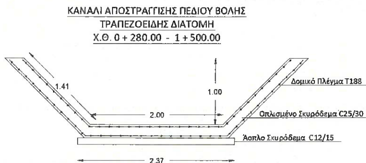
Εικόνα 25.1 Τυπική τραπεζοειδή διατομή αποστραγγιστικής τάφρου (άνευ κλίμακας).
