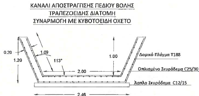
Εικόνα 2.9 Τυπική διατομή για την συναρμογή της αποστραγγιστικής τάφρου με το οχετό (άνευ κλίμακα).
